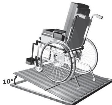
Pour les fauteuils roulants à propulsion manuelle de verticalisation (FRMV), quelle que soit la position du système de soutien du corps (verticalisée ou semi verticalisée), lestés d'un mannequin anthropomorphe, la stabilité statique dans toutes les directions est au moins de 7°.
